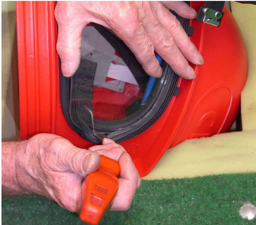
Figure 3 : Montage d'une visière intérieure à l'aide de l'outil de montage
